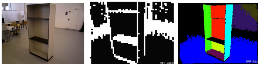
图 11: 平面提取结果。左图是深度图对应的 RGB 图像, 中图是 AHC 方法提取的平面联通区域, 右图是平面分割结果。
