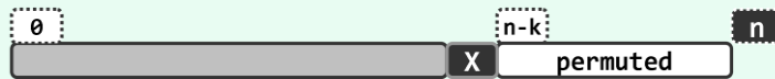
图x2.1 permute()算法中第k + 1个就位元素，应等概率地随机选自当时的前n - k个元素
