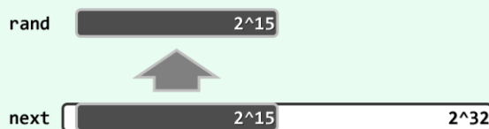
图x2.2 Brian W. Kernighan和Dennis M. Ritchie所设计随机数发生器的原理
