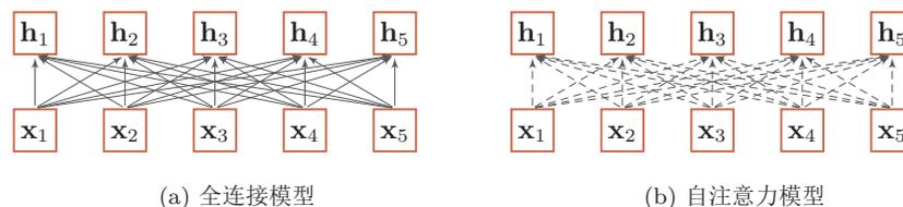
图 8.4 全连接模型和自注意力模型
