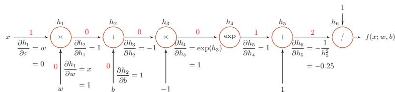
图 4.8 复合函数  $f(x; w, b)$  的计算图
