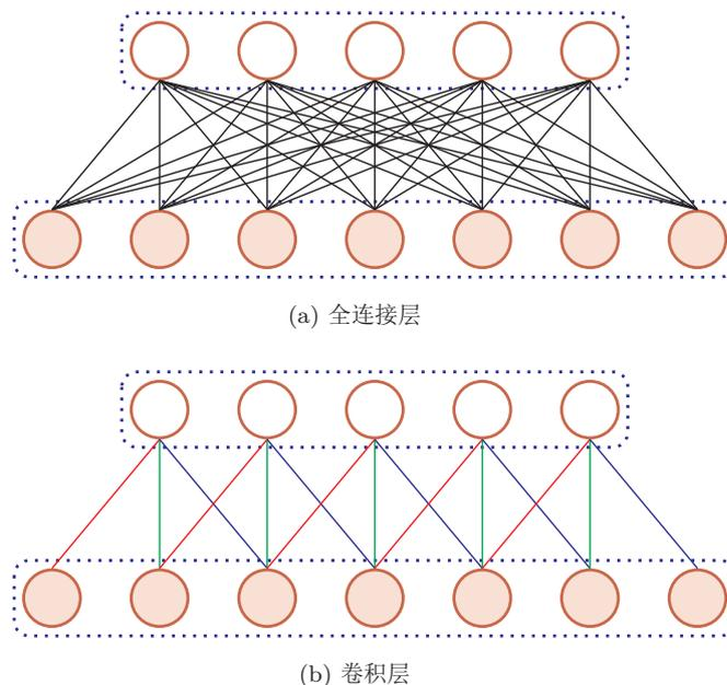
图 5.5 全连接层和卷积层对比
