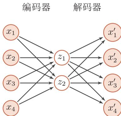
图 9.2 两层网络结构的自编码器
