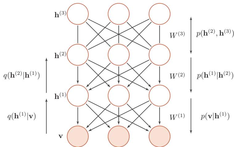
图 12.5 一个有 4 层结构的深度信念网络
