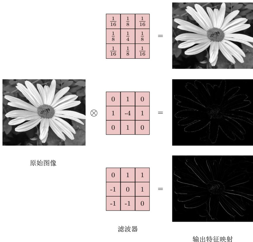
图 5.3 图像处理中几种常用的滤波器示例
