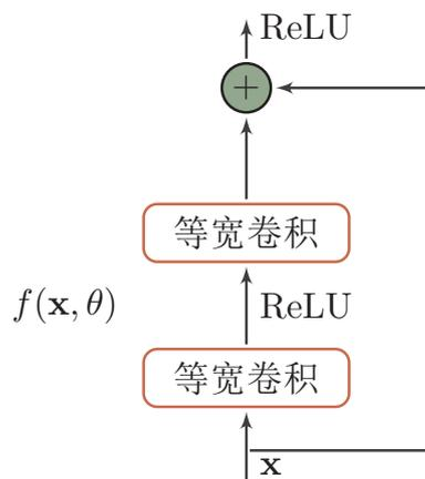
图 5.15 一个简单的残差单元结构
