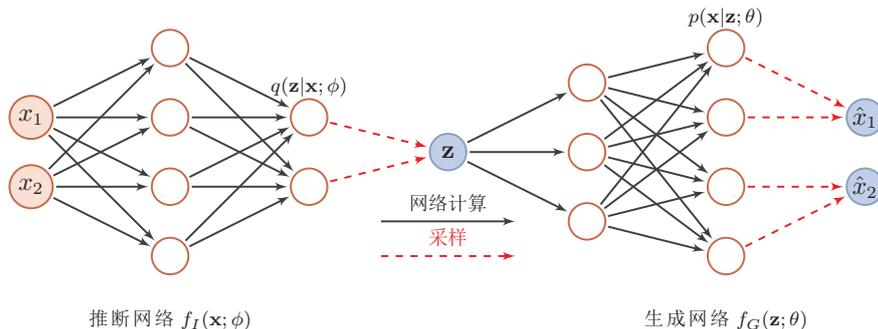
图 13.3 变分自编码器的网络结构
