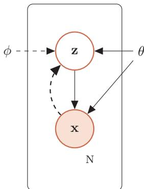
图 13.2 变分自编码器。实线表示生成模型，虚线表示变分近似。
