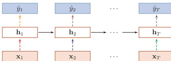
图 7.13 针对非循环连接的丢弃法
