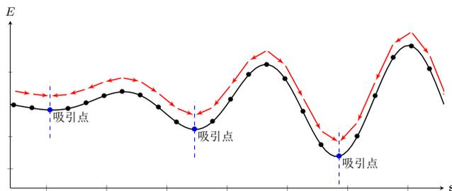
图 8.10 Hopfield 网络的能量函数
