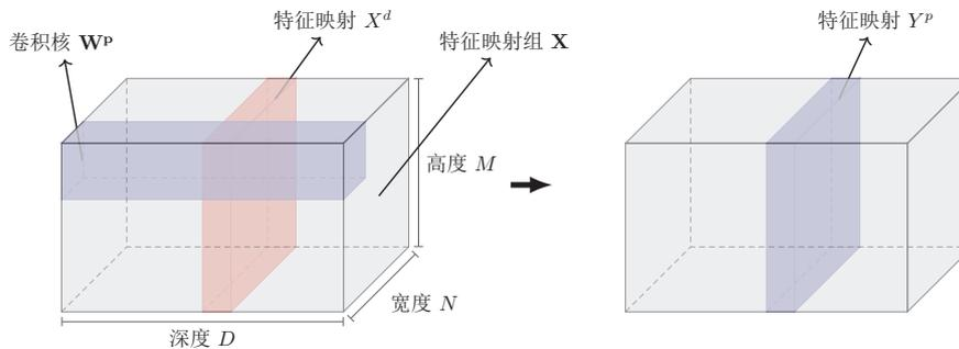
图 5.6 卷积层的三维结构表示
