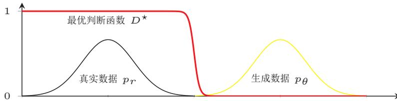
图 13.9 生成对抗网络中的梯度消失问题
