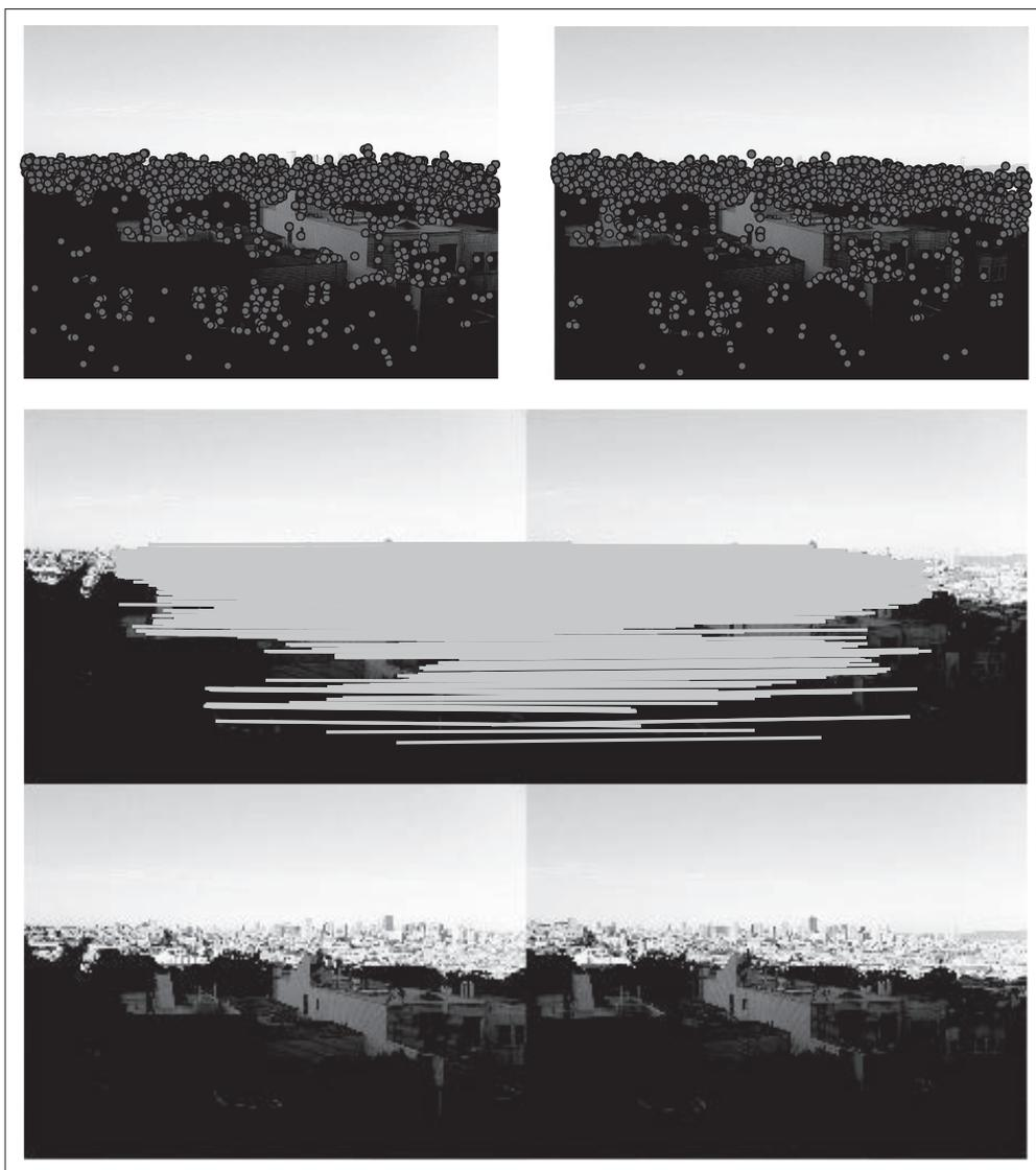
图 2-6：在两幅图像间检测和匹配 SIFT 特征
