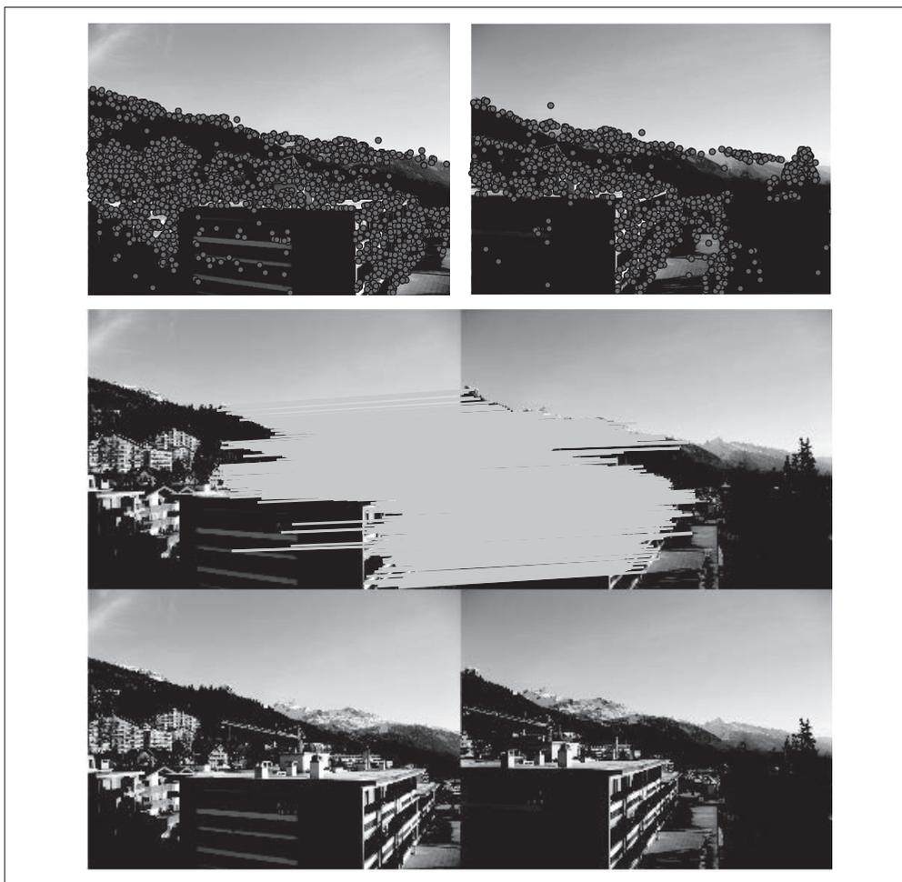
图 2-5：在两幅图像间检测和匹配 SIFT 特征
